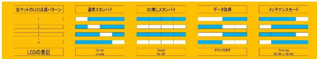
図7：mbed 内蔵 LEDのパターン対応表
