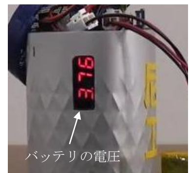
図 6 バッテリ電圧
